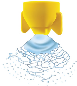
Ілюстрація 1: Silsoe Spray Applications Unit: Тест зменшення знесення: FF11003
